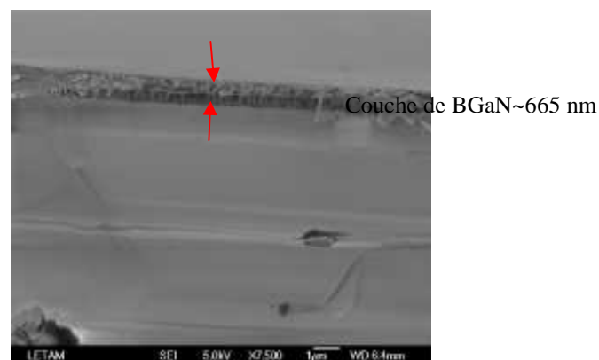
Figure 4: Vue sur la tranche de BGaN/AlN; épaisseur estimée ~665nm
